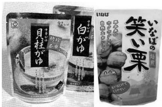
写真3 酸素吸収性(アクティブバリア)レトルトパウチ(構成:PET/アルミ箔/鉄系アクティブバリア材「オキシガード」/CPP)
